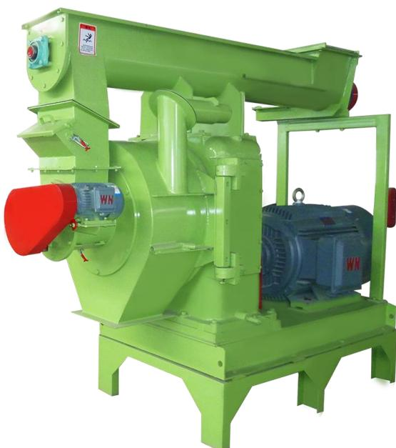
Imagen 7: ejemplo de pelletizadora con mezcladora [
