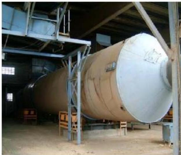
Imagen 4: ejemplo de trómel de secado.
