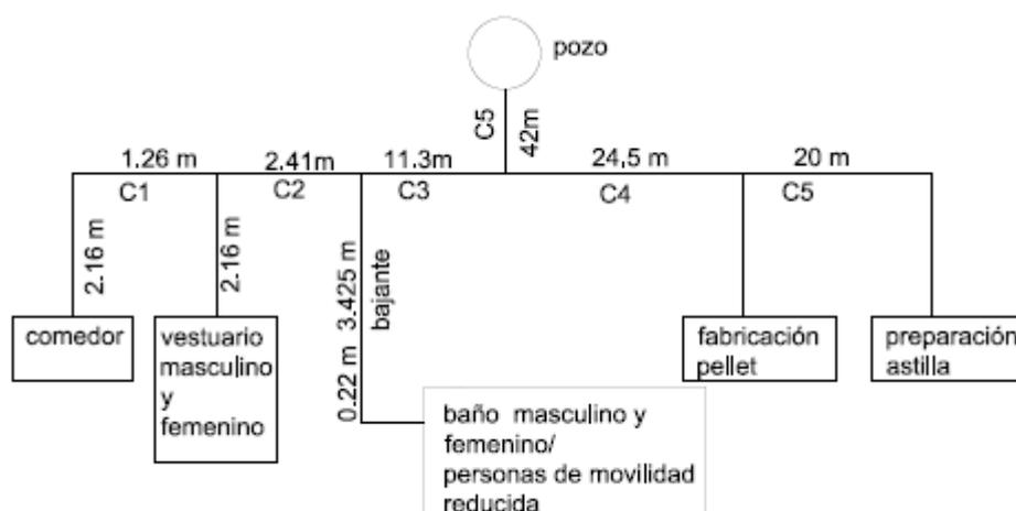
Imagen 16: esquema de los colectores horizontales de la red de aguas negras
