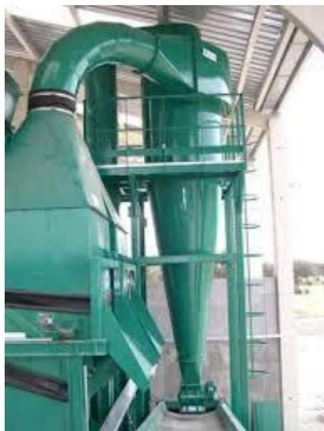
Imagen 5: ejemplo de ciclón decantador
