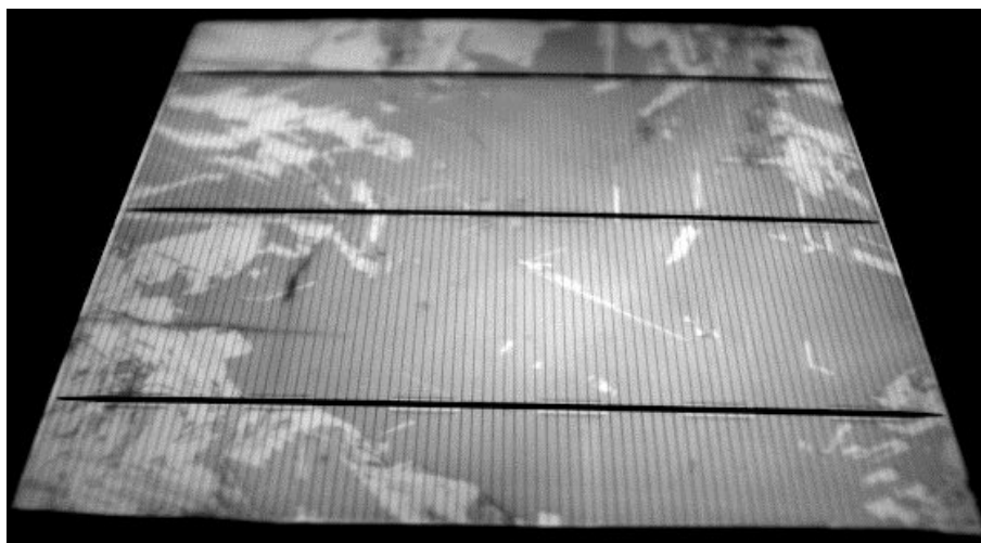
Figura 7.1: Fotoluminiscencia de una célula solar de silicio multicristalino (mc-Si) captada con una cámara CCD de InGaAs.
