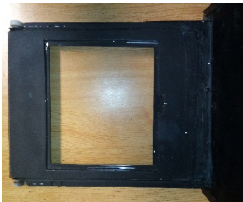
Figura 6.5: Bandeja extraíble para la colocación de las muestras
