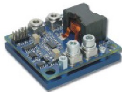
Figura 6.7: Características del driver electrónico y el aspecto físico del dispositivo LDP-C 40-05.
