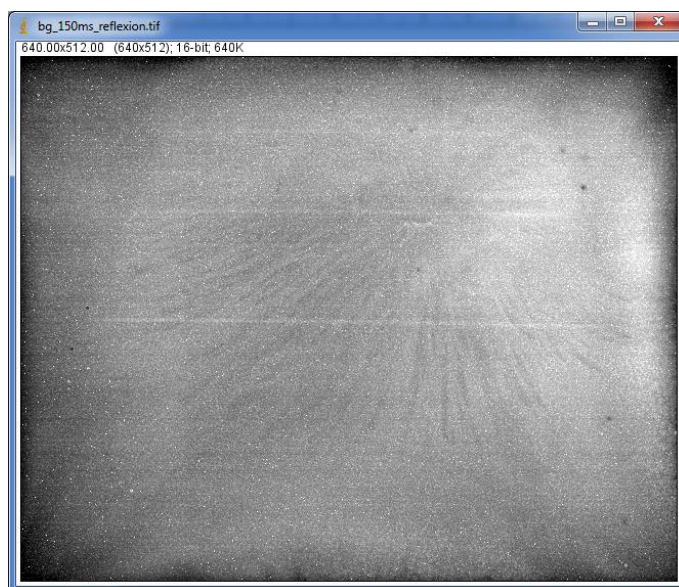
Figura 8.7: Darkfield de una oblea de silicio monocristalina.
