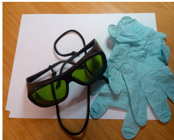
Figura 7.7: Equipos de seguridad empleados en la realización de los ensayos de fotoluminiscencia
