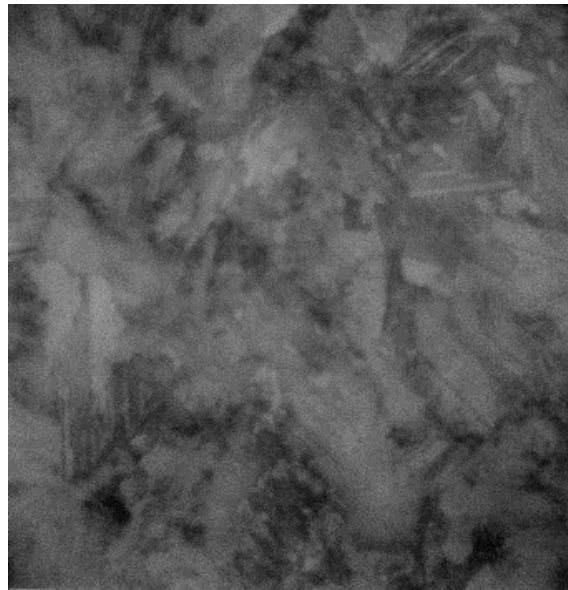
Figura 7.2: Fotoluminiscencia de una oblea de silicio multicristalino (mc Si) captada con una cámara CCD de Silicio.
