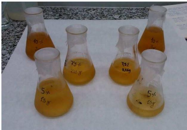
**Figura 3.5.** Hidrolizados de pulpa de remolacha usados para fermentar.
