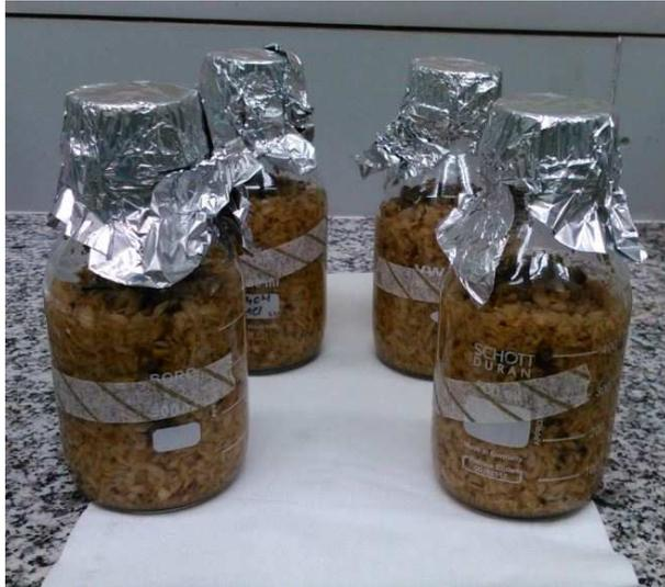
**Figura 3.2.** Ensayos de pretratamiento hidrotérmico de pulpa de remolacha tras ser sacados del autoclave.
