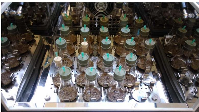
**Figura 3.3.** Ensayos de hidrólisis enzimática en incubadores orbitales.
