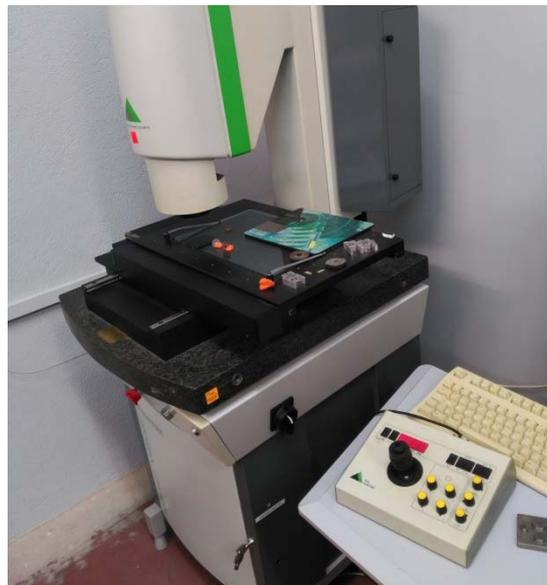
*Figura 3.8. Equipo de obtención y procesamiento de imágenes digitales.*
