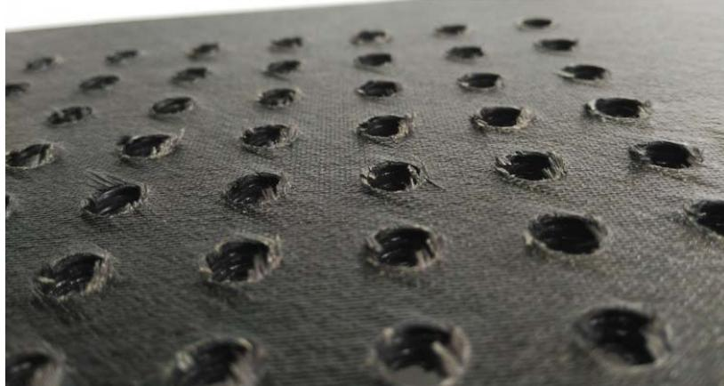
Figura 4.31. Daño por astillamiento y fibras no cortadas a la salida.
