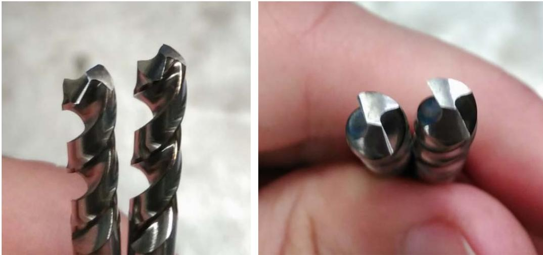
Figura 4.17. Detalles del desgaste (izq. Broca desgastada / dcha. Broca nueva) HSCO1261.
