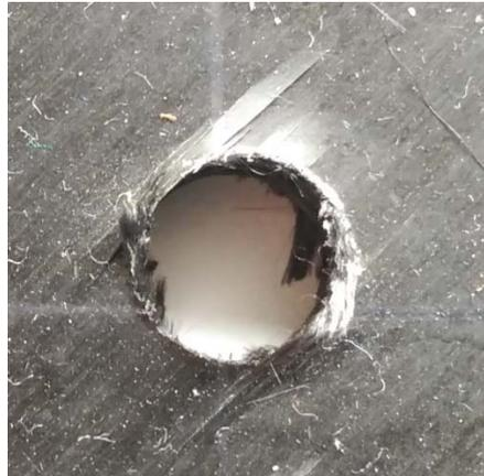
Figura 4.37. Detalle de grietas (levantamiento de fibras longitudinalmente).
