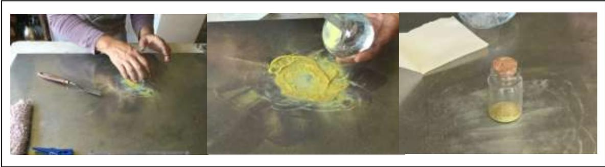
Figura A.60 Proceso de molido y envasado del pigmento en polvo.
