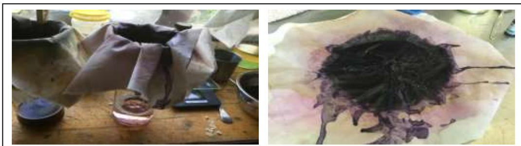
Figura A.45 Filtración de la mezcla en forma de pasta para separar el pigmento.
