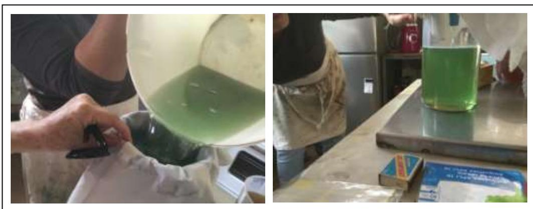
Figura A.33 Colamos varias veces hasta que el agua vaya quedando transparente y todo quede en la tela por filtración. Fuente: elaboración propia.
