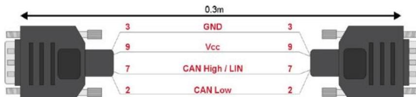
Ilustración 7: Pinout de los conectores DB9 del CANcaseXL..
