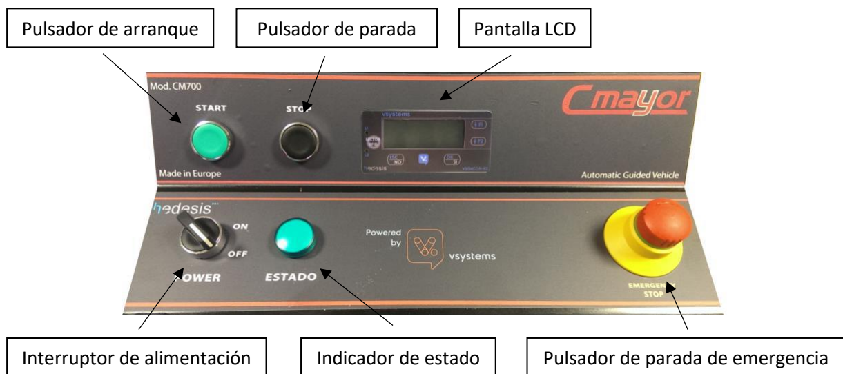
Imagen 12. Panel frontal de control de un AGV
