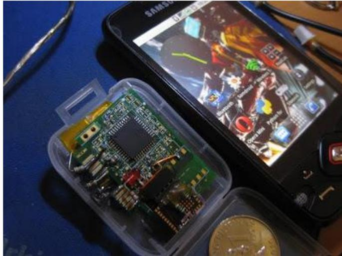
**Figura 19. Placa controladora del osciloscopio con módulo Bluetooth**
