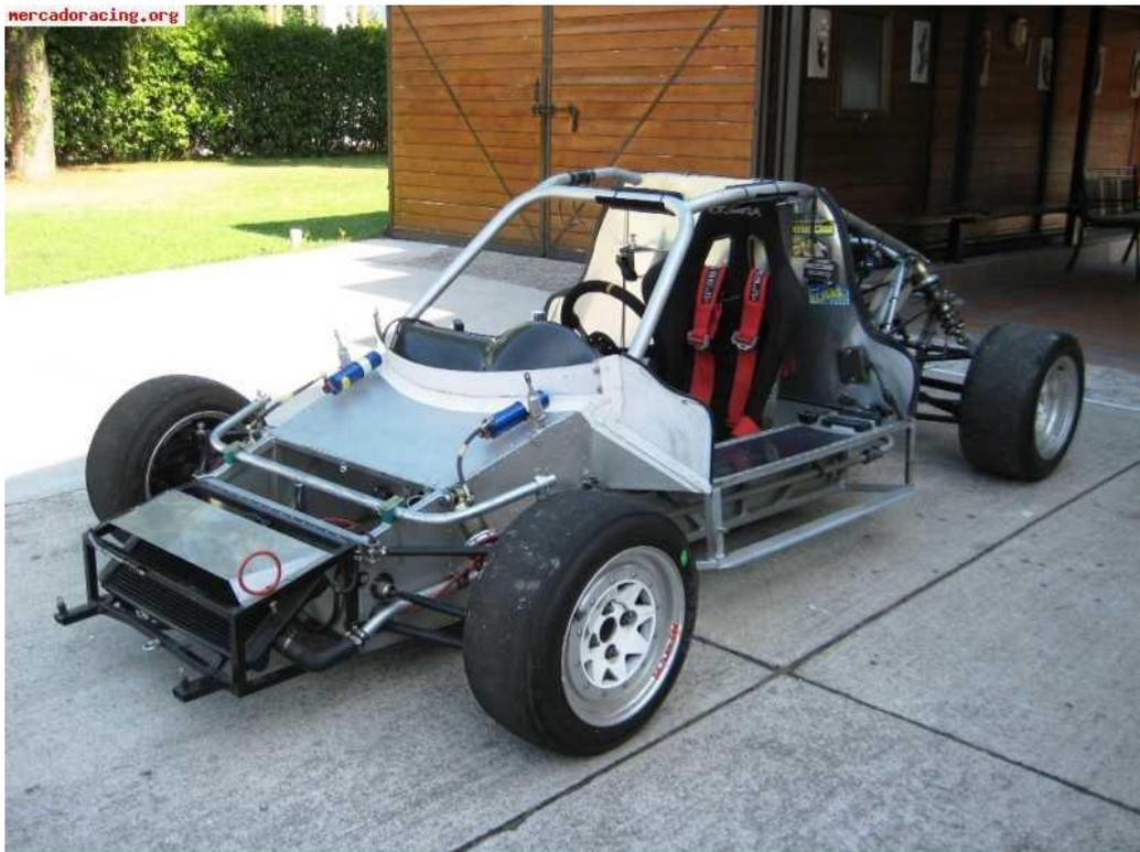
Fig. 1.2: Ejemplo de barqueta construida en 2008 por Bango Racing Cars y con motor Suzuki.
