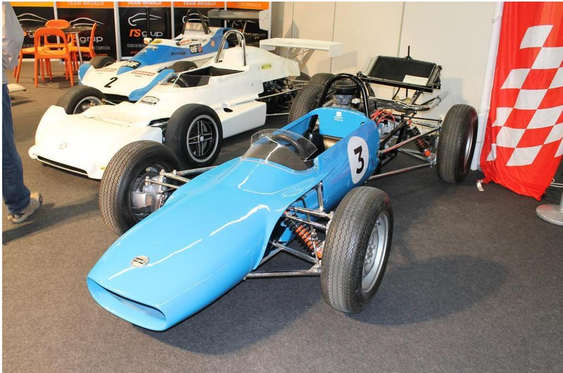
Fig 2.3: Fórmula SEAT 1430 (1970). Se aprecia la suspensión de tipo dobles triángulos
