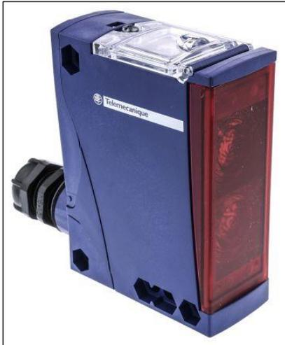
fotoeléctricos (Resnick\_halliday s.f.) para la detección de presencia pieza. El principio de funcionamiento de este tipo de sensor es el siguiente: son sensores cuyos elementos de emisión y recepción están yuxtapuestos en el mismo conjunto óptico. Los rayos emitidos por el transmisor se reflejan en la superficie del objeto detectado y retornan al elemento receptor.
