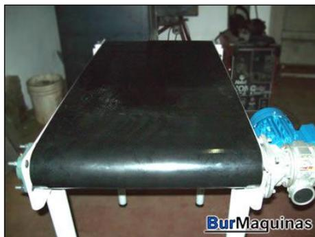
Figura 9 – Transportador de Banda
