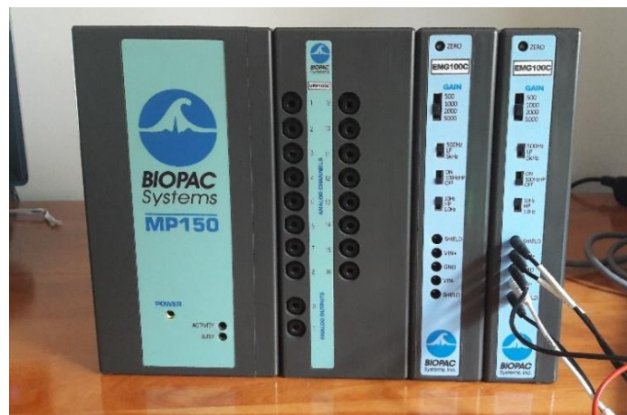
Figura 35.- Biopac Systems MP 150. Equipo de adquisición de datos.
