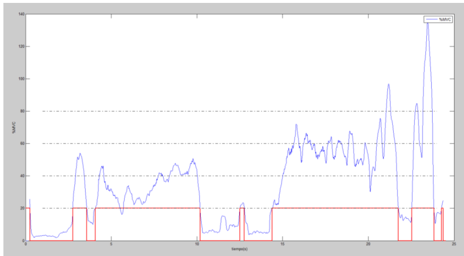
Figura 45.- Señal de activación generada tras la primera etapa de la detección muscular
