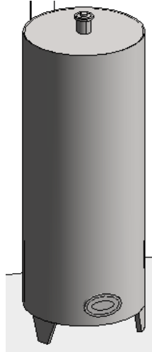
Figura 12. Vista en Revit de un tanque de fermentación
