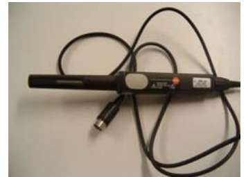
Tres sondas de CO 2 marca Testo modelo 0632-1240.
