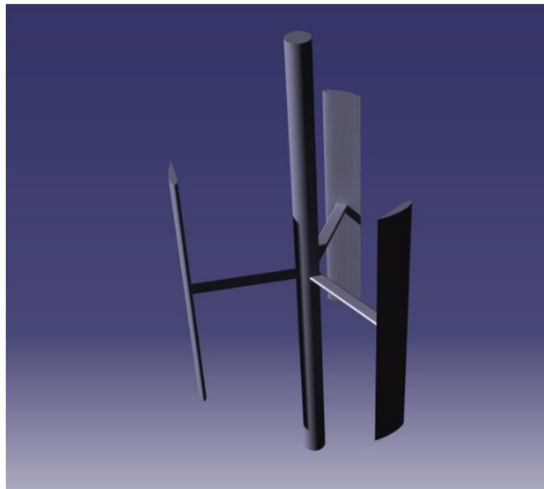
Figura 2.4 Vista 3D del aerogenerador de estudio
