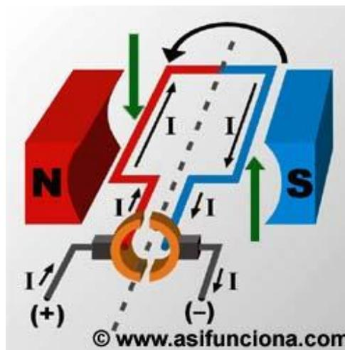
Figura 12 Funcionamiento Motor DC
