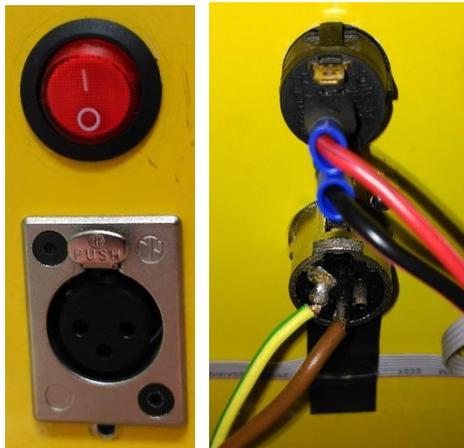
*Figura 18 Interruptor general y cargador, parte exterior (imagen izquierda), parte interior (imagen derecha).*
