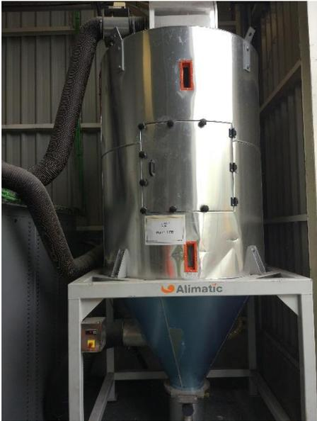
*Ilustración 18 Estufa de material (marca Alimatic)*
