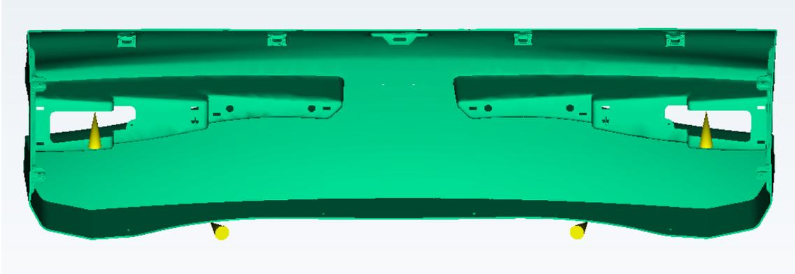
**Modelo D:** 5 Puntos de Inyección, la localización sería dos puntos en la arista inferior de la pieza, otro en la zona logo y otros dos en la zona pilotos.
