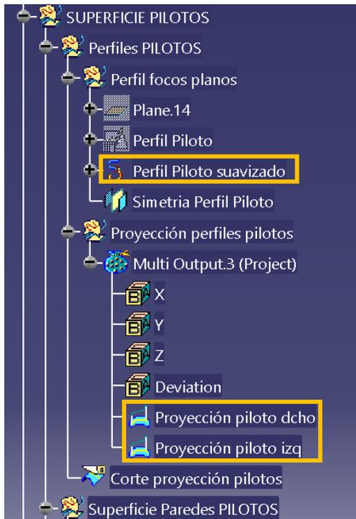
Los pilotos serán de grandes dimensiones en proporción con la pieza, ya que aparte de un elemento decorativo es un elemento de seguridad. Se crea el perfil en un plano auxiliar fuera de la pieza y luego se proyectan los perfiles. A continuación se corta la superficie proyectada con el comando "Split"
