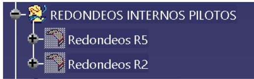
Con el comando Edge Fillet se seleccionan los vértices a redondear. Primero se realizan los verticales, y luego todo el borde interior. A 5mm y 3 mm respectivamente.
