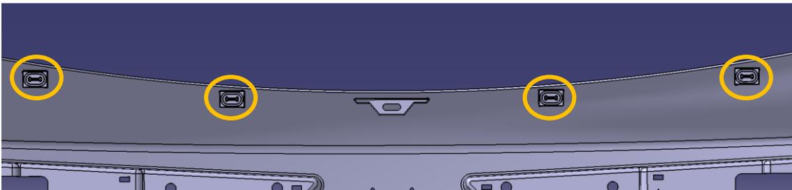
Estos cuatro anclajes sirven para fijar la pieza al vehículo por la parte superior. Todos ellos tienen un saliente, llamado porta-grapa en el que se coloca una grapa y al montar el portón por presión en vertical quedará fijado con el vehículo. Para facilitar el clisado de todas las grapas se coloca unos centradores en la zona trasera de los pilotos que nos ayuda a que la pieza se monte totalmente recta.
