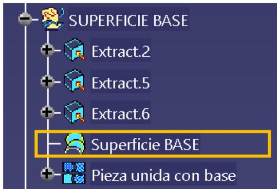
La superficie que falta es la inferior que hace de borde inferior de la pieza, la hemos llamado base, ya que es donde se apoyara la pieza desnuda, montada en vehículo será la que este en contacto con la parte superior del paragolpes trasero.
