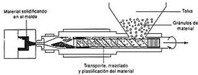
Ilustración 25 Plastificación del material
