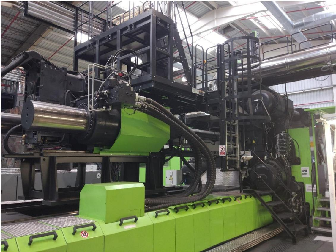
Ilustración 2 Máquina de inyección Engel 3200
