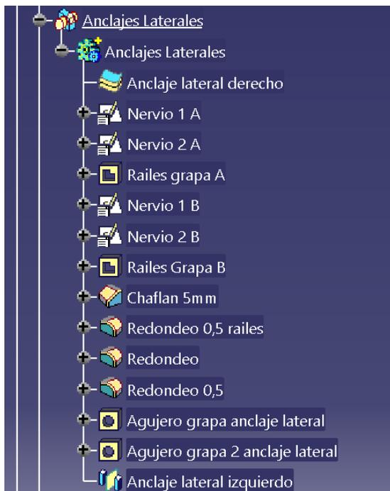
Anclajes laterales: se utilizan para ajustar los laterales de la pieza y que quede perfectamente alineada con el resto de la carrocería en estos laterales.
