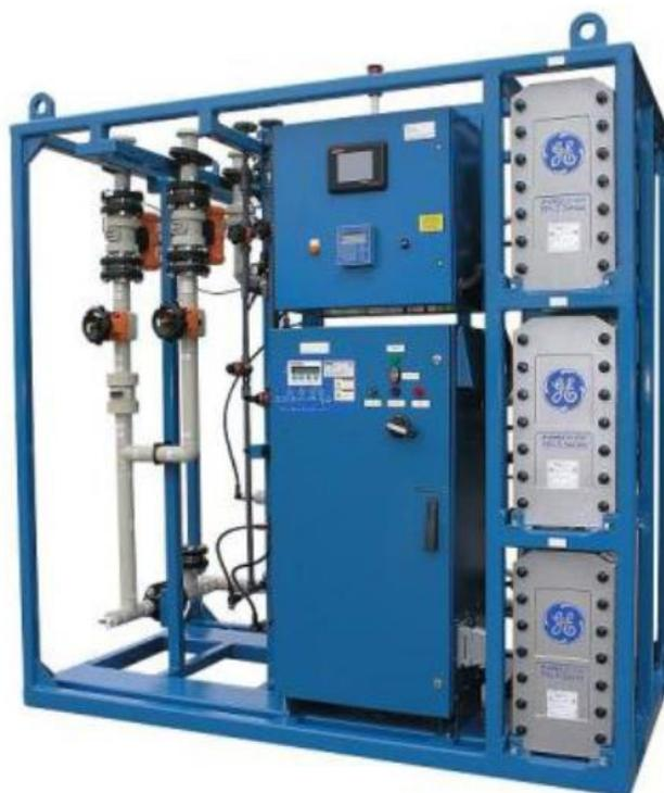
Figura 5.8. Electrodesionizador, modelo GEMK3.
