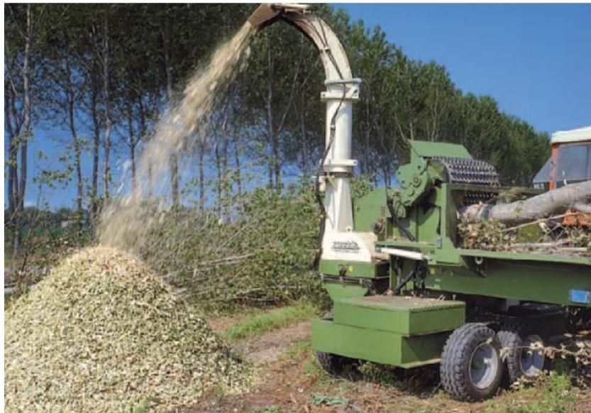
Figura 2.5. Astilladora durante el proceso de astillado de un tronco de madera [30].
