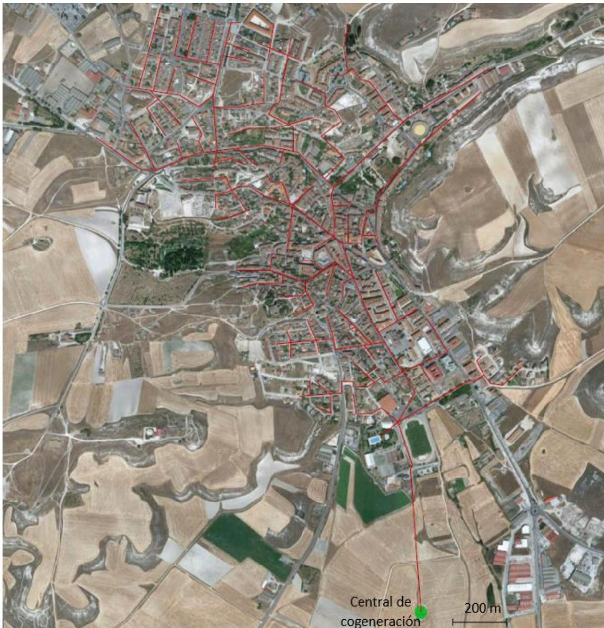
Figura 5.21. Distribución de la red de tuberías de ida del DH.
