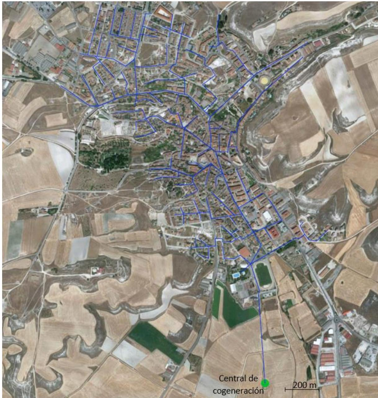
Figura 5.22. Distribución de la red de tuberías de retorno del DH.
