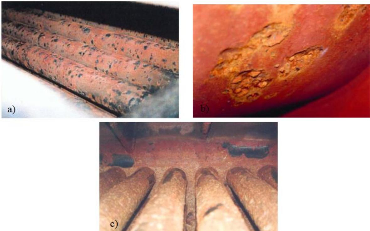
Figura 5.6. a) Corrosión por oxígeno. b) Corrosión por sosa caustica. c) Incrustaciones [97].
