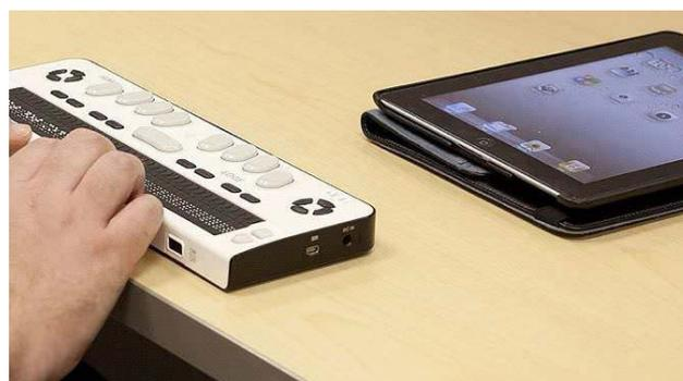
Figura 47: Dispositivo de entrada Braille (teclado) para tablet
