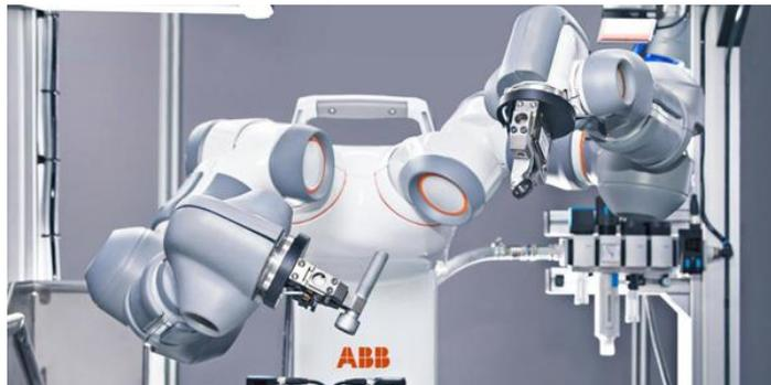
*Ilustración 4: Robot colaborativo de ABB*
