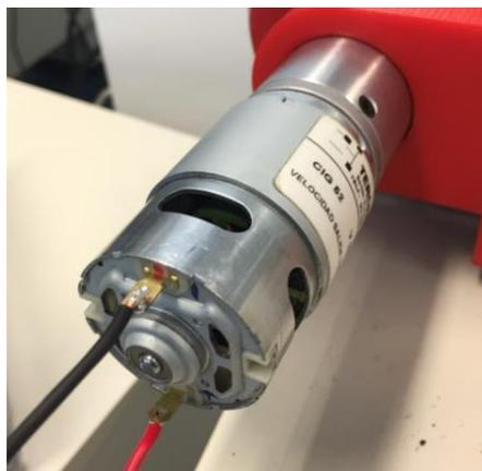
*Ilustración 52: Motor Tercesa de la segunda cinta transportadora*
