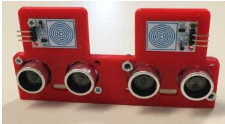
*Ilustración 53: Parte delantera del soporte de sensores*
