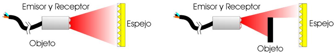
Ilustración 22: Sensor óptico reflexivo con reflector
