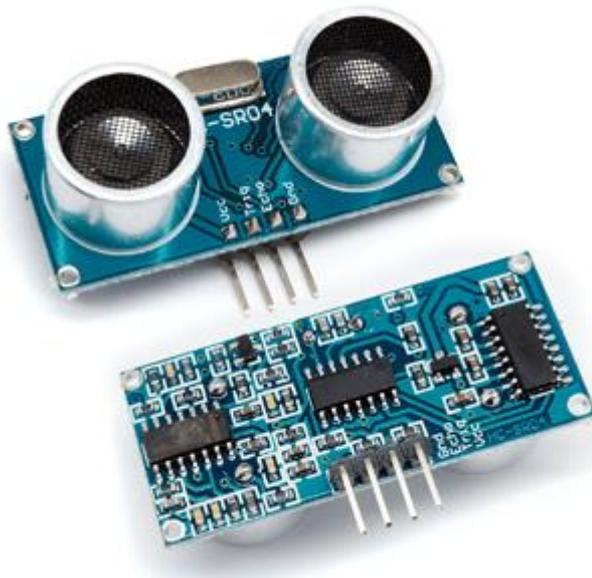
*Ilustración 33: Sensor ultrasónico HC-SR04*
