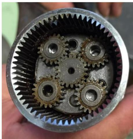
*Ilustración 58: Reductora del motor Tercesa*
