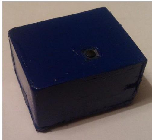
*Figura 32: Encapsulado final tras lijado y pintado.*
