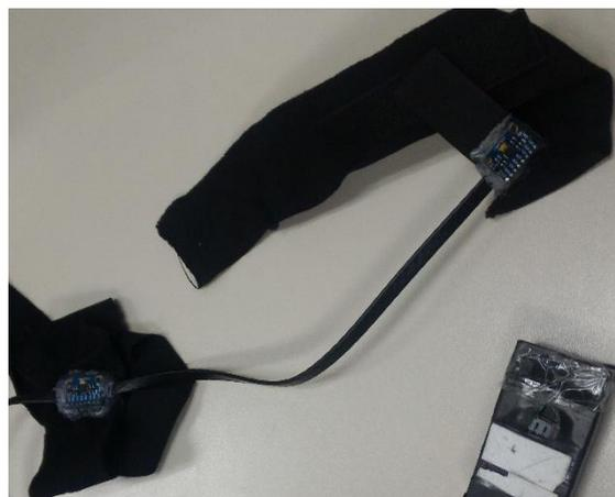
*Figura 7: Conexión entre los dos MPU6050 mediante ethernet plano.*
