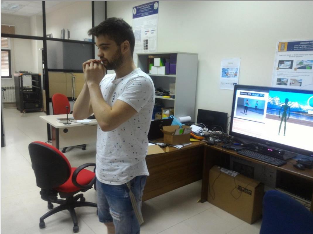
*Figura 64: Detección incorrecta por auto-oclusión y posición de espaldas a la cámara.*
