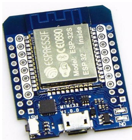
Figura 35: Imagen real de la placa Wemos MINI D1 ESP32
