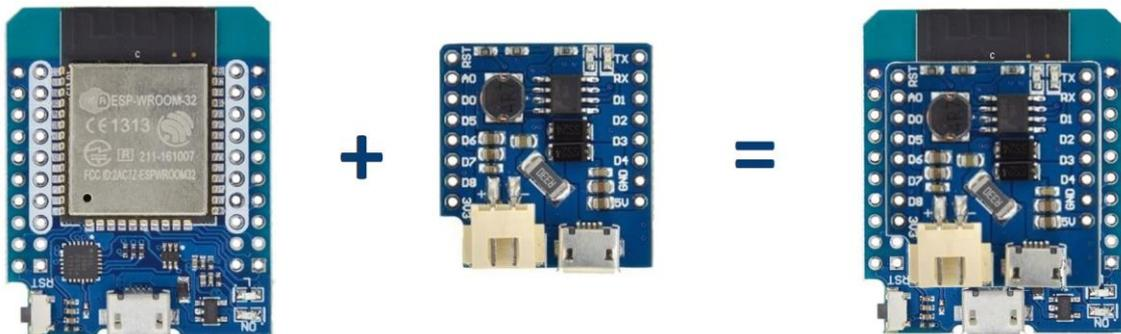
Figura 26: Wemos ESP32 con placa de carga.
