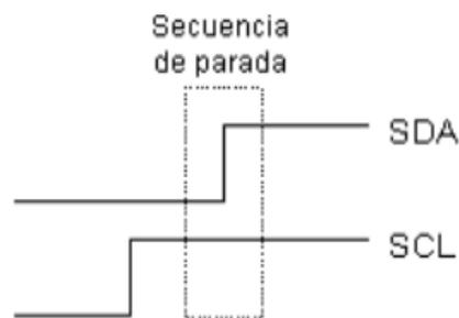
Figura 41: Condición de parada de I2C.
