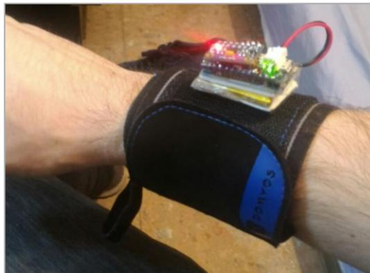
*Figura 20: Dispositivo bluetooth autónomo colocado para medidas de muñeca.*
