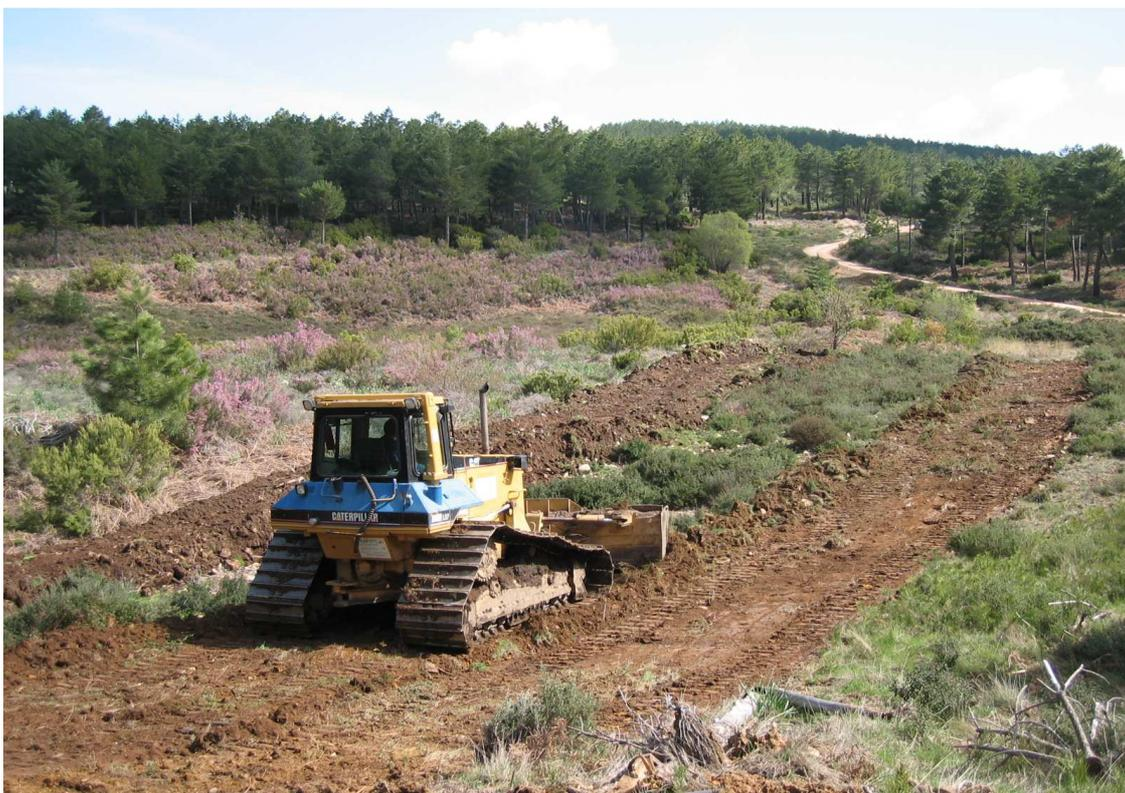
**Foto 7.1.3. Bulldózer D-6 realizando limpieza de cortafuegos.
