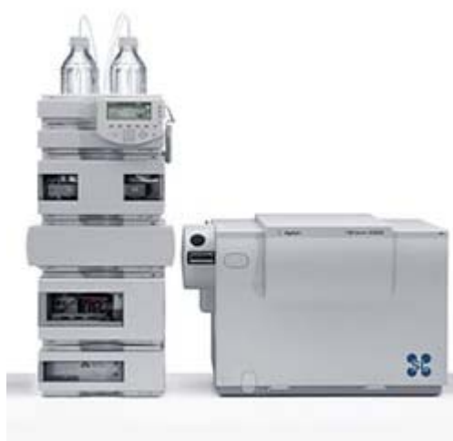
Figura 3: Esquema del equipo de HPLC–MS empleado
