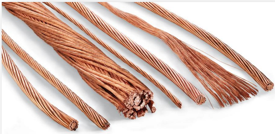
Fig.9. El cobre es un ejemplo de buen conductor.
