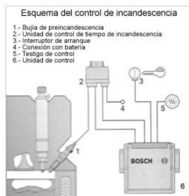
Fig. 64 - Esquema de un sistema de precalentamiento (<http://www.aficionadosalamecanica.net/>)
