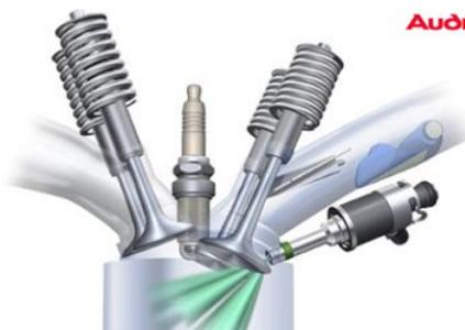
**Fig. 37 – Sistema de inyección directa (AUDI)**
