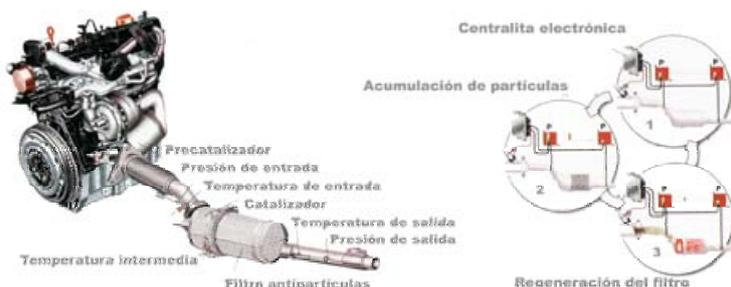
Fig. 58 - Esquema de un motor con FAP (<http://www.aficionadosalamecanica.net/>)
