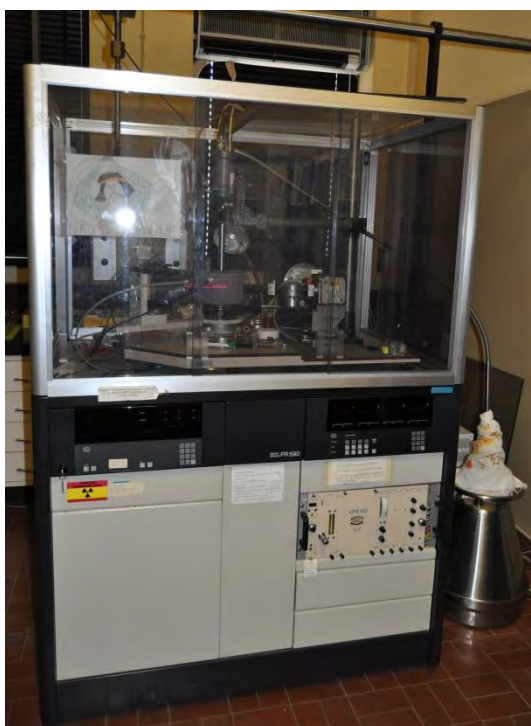
Figura 30. Difractómetro de polvo INEL CPS120
