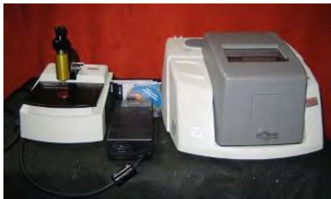
Figura 29. Espectrómetro compacto Thermo Nicolet 380 FT-IR
