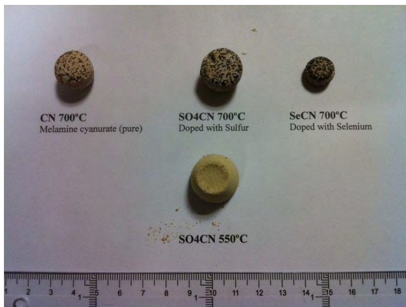
Figura 22. Aspecto de las muestras para las tres familias tras tratamiento 50 minutos a 700°C en crisol cerrado con tapa, y para el SO4CN a 550°C.
