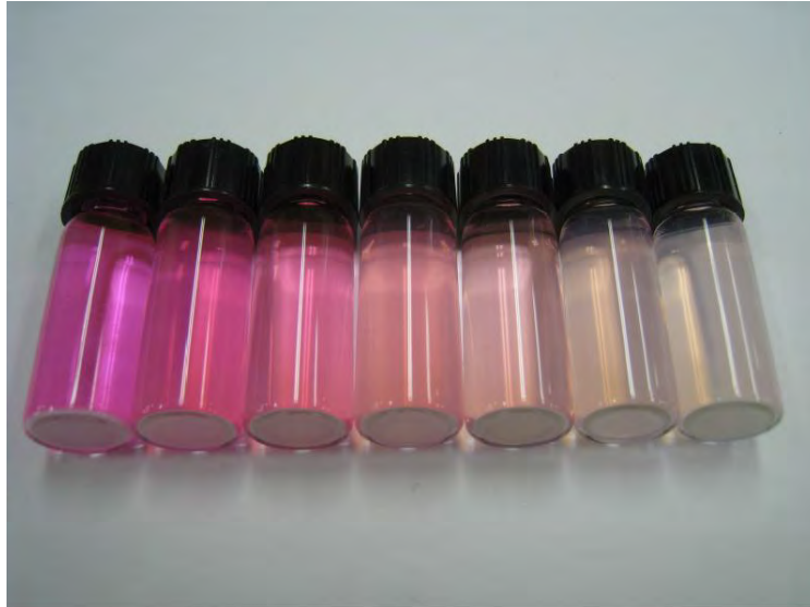
Figura 71. Cambios de color asociados a la degradación gradual de la rodamina B.
