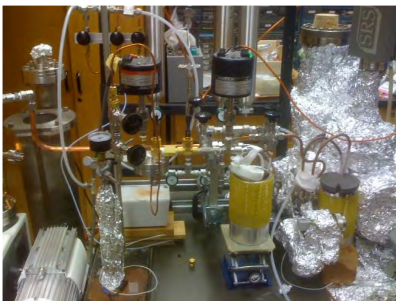
Figura 68. Vista general de la línea de gas de ultra alto vacío que permite la conexión al espectrómetro de masas
