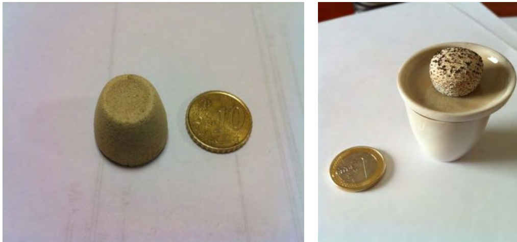
Figura 21. Aspecto de una muestra de CNM tras tratamiento a 550 °C ( izquierda ) y 700°C ( derecha ) durante 50 minutos en crisol cerámico con tapa
