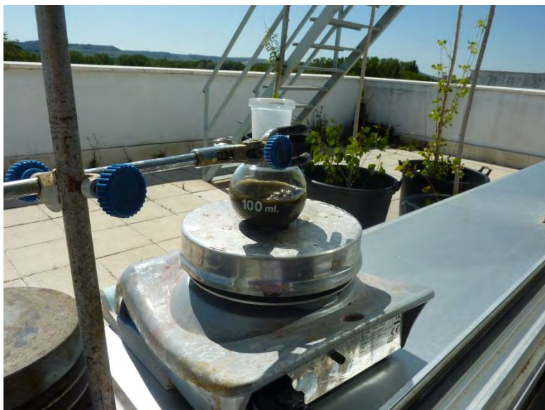
Figura 70. Ensayo de irradiación de solución de naranja de metilo con luz solar.
