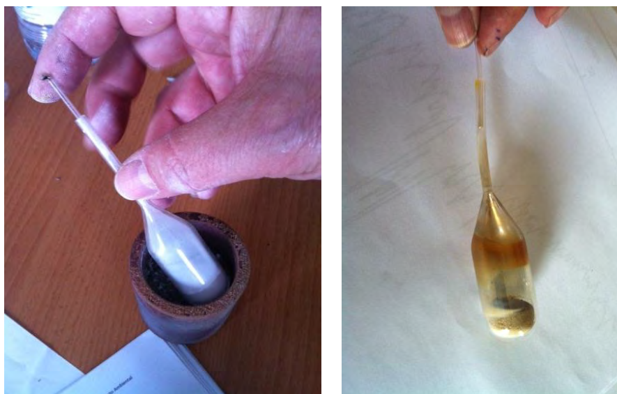
Figura 20. Trabajando en ampolla de vidrio cerrada a 700°C: antes del tratamiento ( izquierda ) y después del tratamiento ( derecha ).
