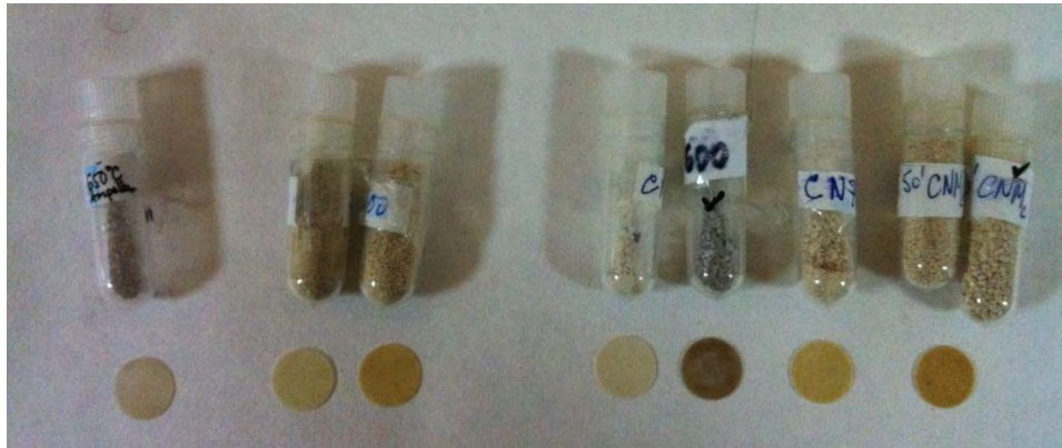
Figura 25. De izquierda a derecha: CN+Al 2 O 3 tratado a 650°C; SO 4 CN a 550°C y a 700°C; CNM a 550°C, 600°C y 700°C.
