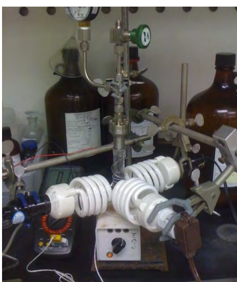
Figura 67. Sistema de irradiación
