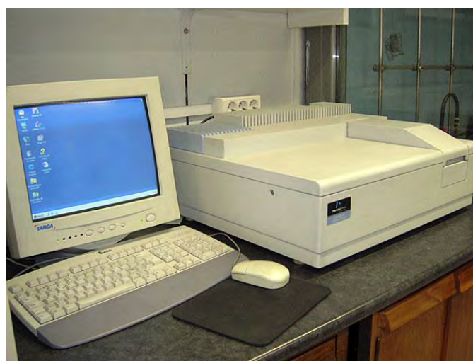
Figura 34. Espectrofotómetro UV-visible Perkin Elmer Lambda 35 con esfera de integración
