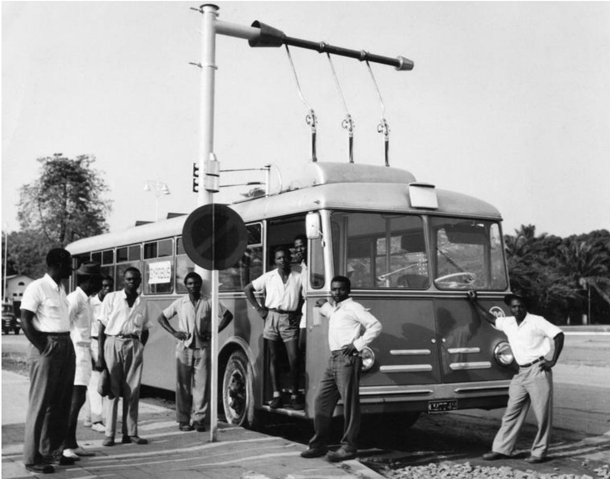
Figura 3. Girobus en una estación de recarga en Kinshasa [Copex, 2004]
