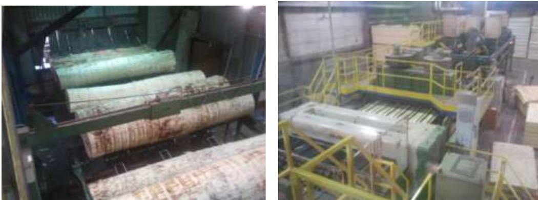
Figura 13. Izq.: Entrada de trozas del clon I-214 al torno. Dcha.: Apiladores.
