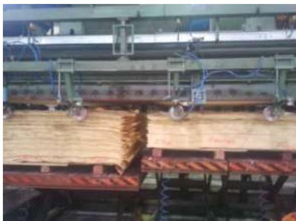
Figura 31. Detalle de los apiladores de chapa para cada calidad.
