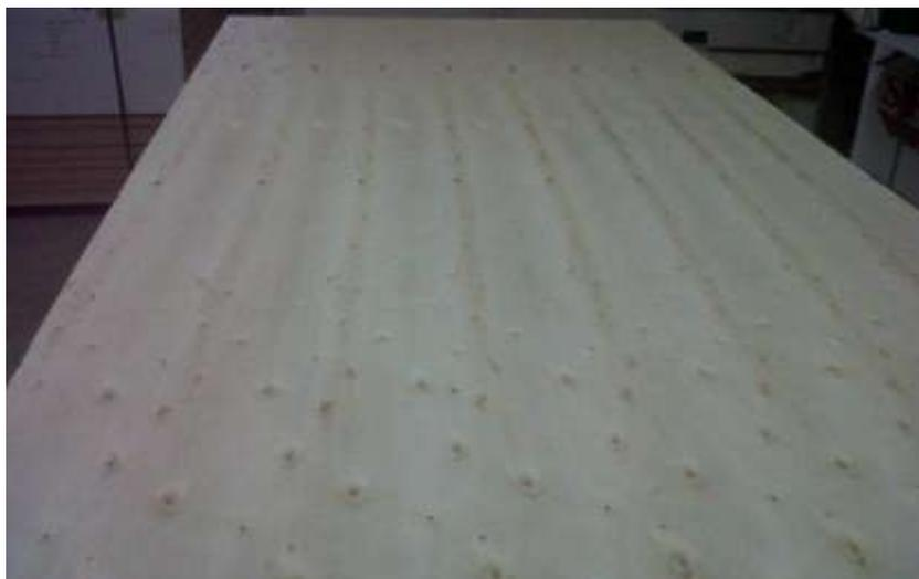
Figura 14. Detalle de la chapa ya apilada por tipo de calidad del clon I-214.
