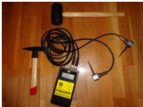
Figura 18. Detalle del equipo Fakopp Microsecond Timer.
