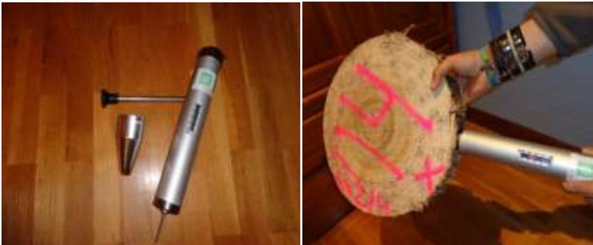
Figura 33. Izq.: Detalle del Pilodyn. Dcha.: Detalle de la toma de datos con el Pilodyn.
