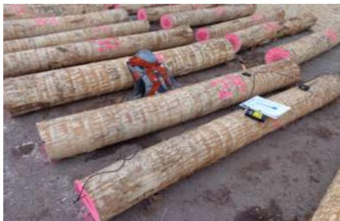
Figura 26. Medición de ultrasonidos de la troza del clon I-214 en parque con el equipo Fakopp.
