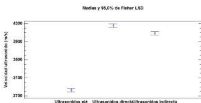
Figura 60. Gráfico de medias, para el clon I-MC, de la velocidad de ultrasonidos tomada sobre el árbol en pie y sobre la troza.
