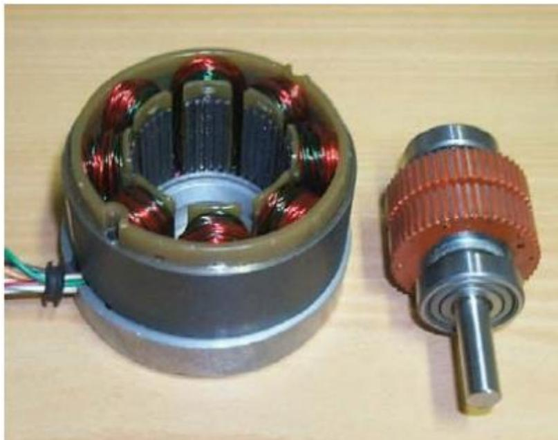
Figura 13: Constitución del motor PaP Híbrido
