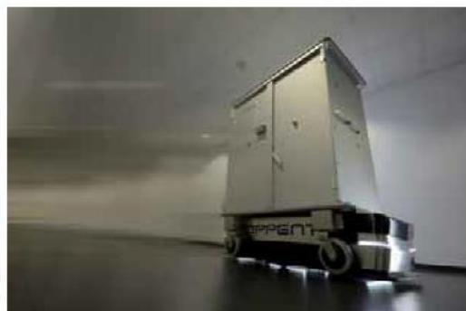
La navegación de los vehículos AGV es completamente autónoma y no requiere instalación alguna ni en paredes ni en suelos. Control:
