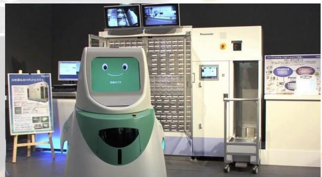
Fue diseñado con formas redondeadas con forma de cubo invertido, dispone de una pantalla de unas 20 pulgadas que muestra una cara feliz para realizar su función en el entorno hospitalario. Una de sus tareas principales es el transporte de medicamentos, que entrega con exactitud, en hora y destino, al personal sanitario para que se los administren a los pacientes hospitalizados.
