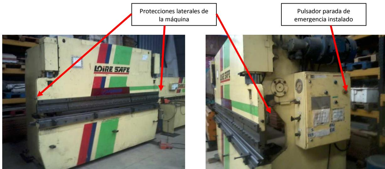
Protecciones laterales de la máquina
