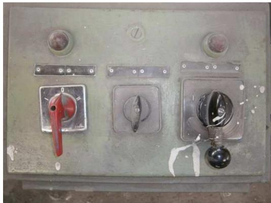
Ilustración 9. Órganos de accionamiento de tipo selector
