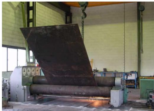
Ilustración 1. Dobladora calderería
