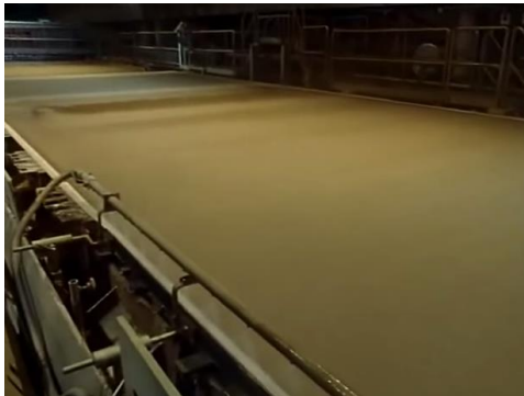
Ilustración 83. Fibras de cartón sobre tela metálica
