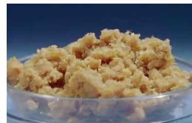
Ilustración 81. Pasta de fibras de madera
