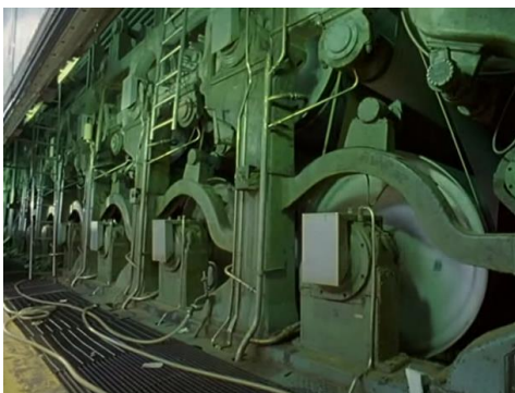
Ilustración 84. Izda. Secador de cartón. Drcha. Rollo de cartón
