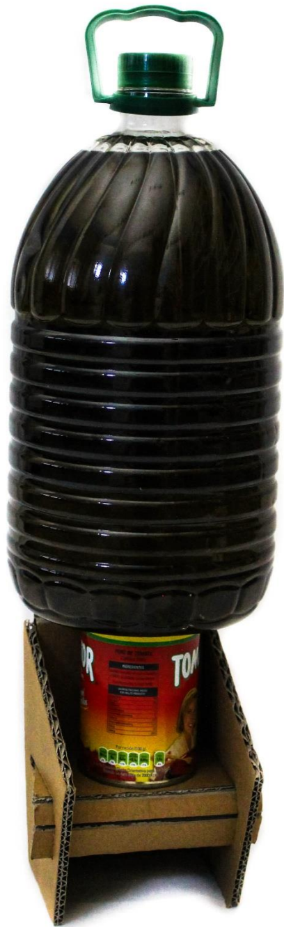
Ilustración 51. Prueba de pesos sobre la maqueta de cartón corrugado
