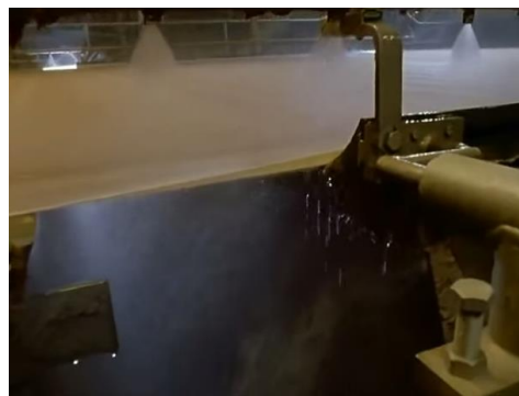
Ilustración 83. Fibras de cartón sobre tela metálica
