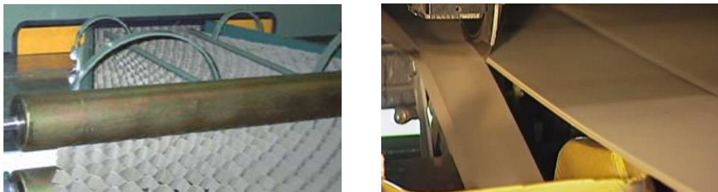
Ilustración 86. Izda. Expansora de cartón; Drcha. Cortadora de cartón
