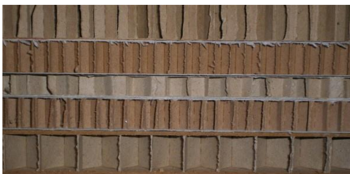
Ilustración 53. Perfil de varios tipos de cartón nido de abeja
