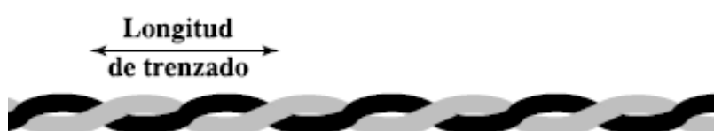
Figura 8 Constitución de par trenzado.
