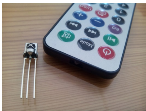
Figura 69. Receptor de infrarrojos y mando a distancia.
