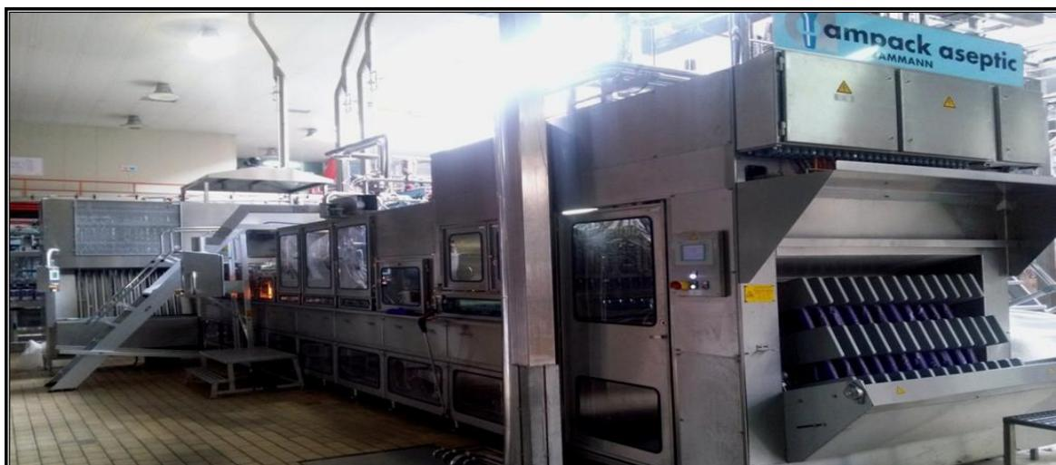
**Figura 5:** Detalle de envasadora/etiquetadora de yogures **AMPACK AMMANN ASEPTIC**
