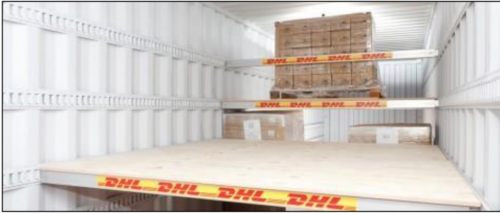
Figura 5.9. Solución de estiba a doble altura en contenedores ó trailers. Fuente: Cadenadesuministro.es
