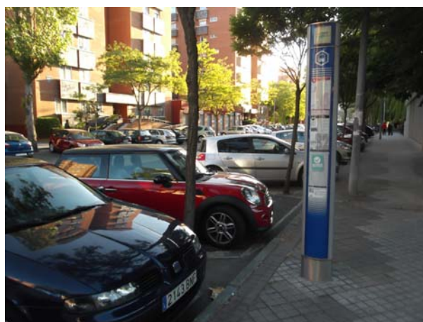
Figuras 124 y 125. Sin protección en inicio/ fin de parada de autobús con elementos rígidos (que eviten la invasión de otros vehículos a la misma), paradas 1120 y 576.
