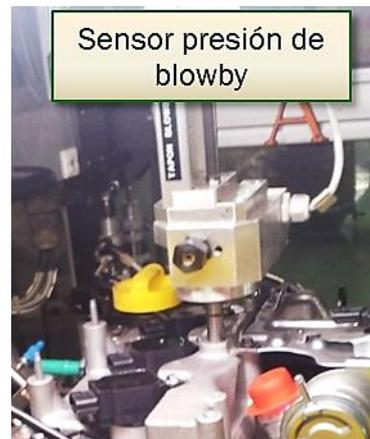
Figura 2.10. Sensor de presión de blowby
