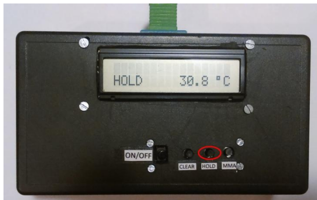
Desactivación del apagado automático
