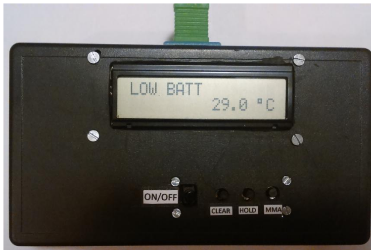
Mensaje indicador de batería baja
