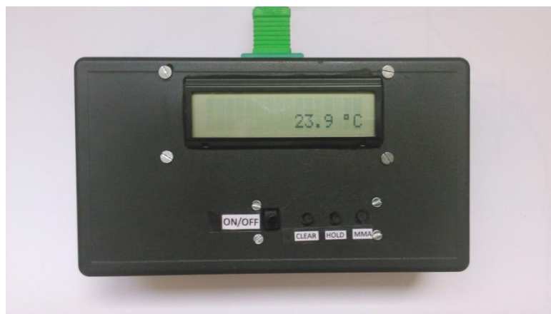
Figura 20. Parte frontal del termómetro con el display y los botones pulsadores
