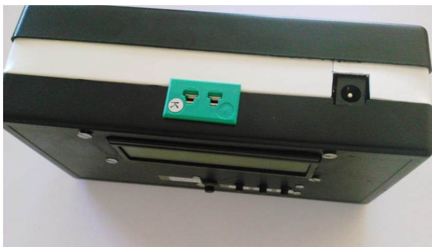
Detalle de los conectores de termopar y adaptador de corriente.
