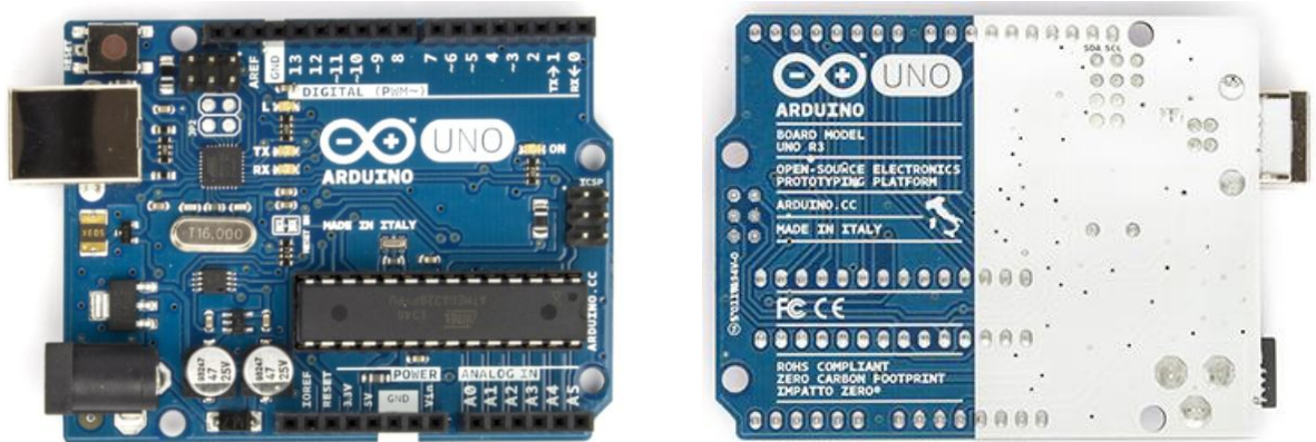
Figura 3. Vista frontal y trasera de la placa Arduino UNO
