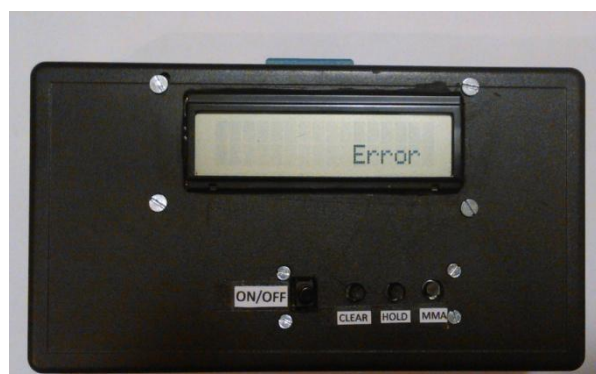
Mensaje de desconexión o rotura de termopar
