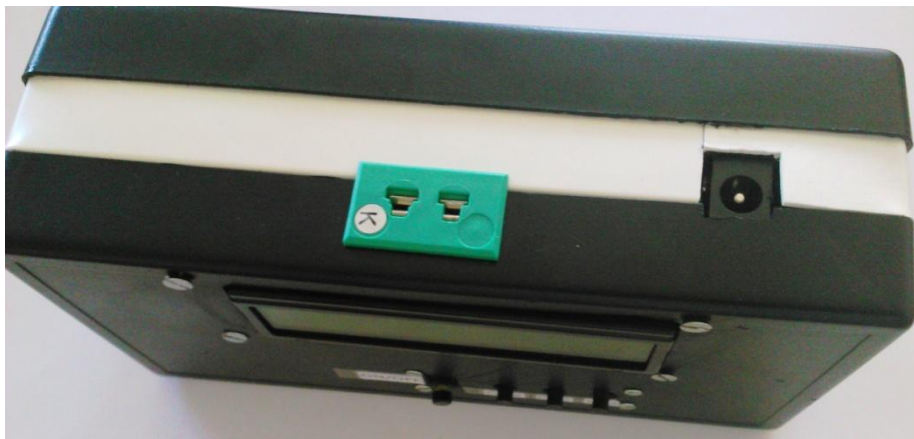
Figura 22. Conectores para termopar y adaptador de corriente
