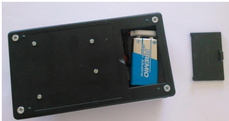
Detalle de la conexión para la pila.
