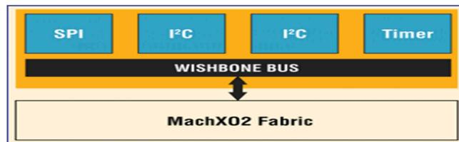
Figura 21: Esquema conexiones del bus WISHBONE.
