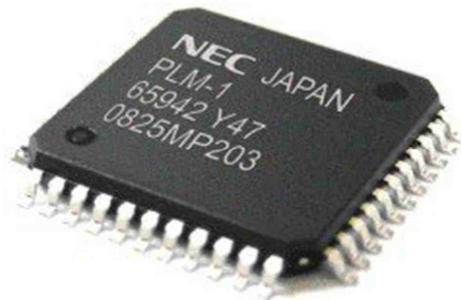
Figura 10: Fotografía de dispositivo ASSP.
