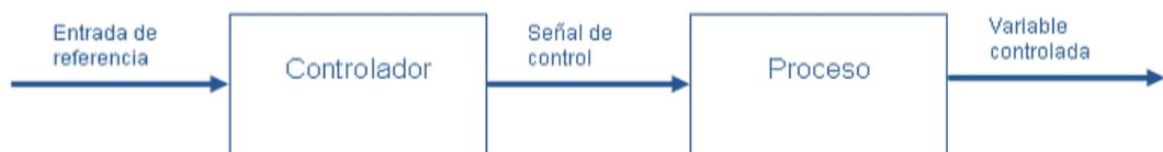
**Figura 9-** Diagrama de bloque de un proceso de control en lazo abierto.
