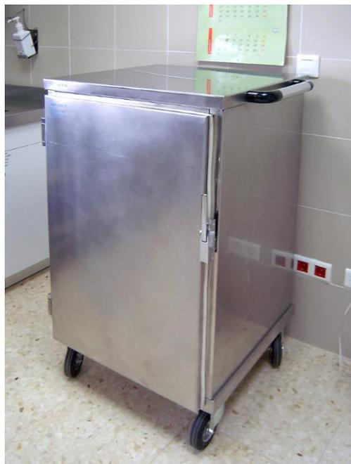
Figura 6.20. Carro hermético para el transporte.
