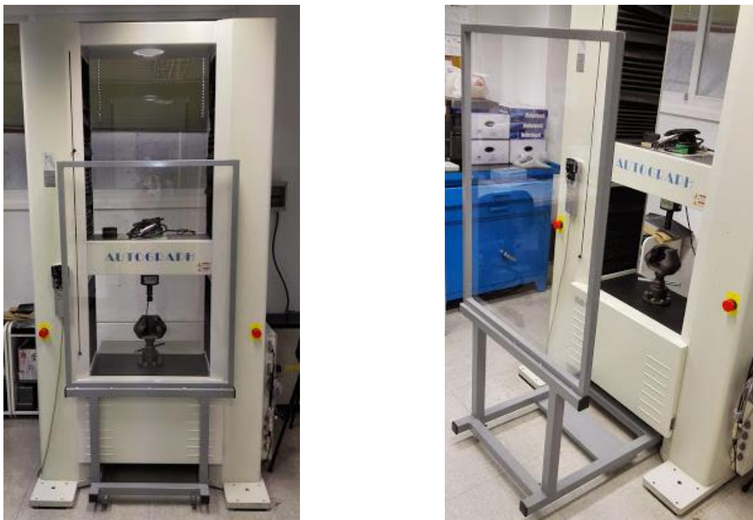
Figura 4.18: Máquina generadora de fuerza y pantalla de protección
