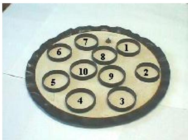
Figura 17. Placa cerámica para el equipo de pF con cilindros de volumen conocido enumerados para su correcta identificación, y que posteriormente se llenarán de muestra suelo.
