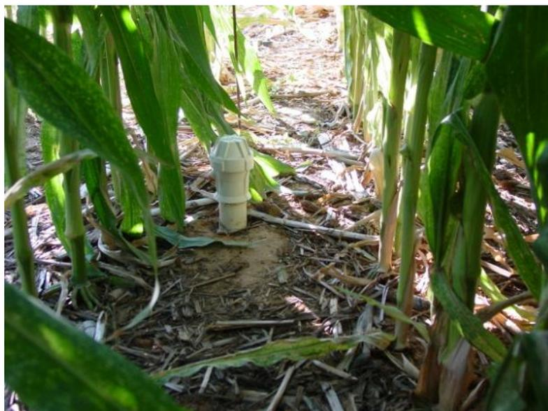
Figura 13. Tubos de acceso para la sonda FDR en no laboreo.
