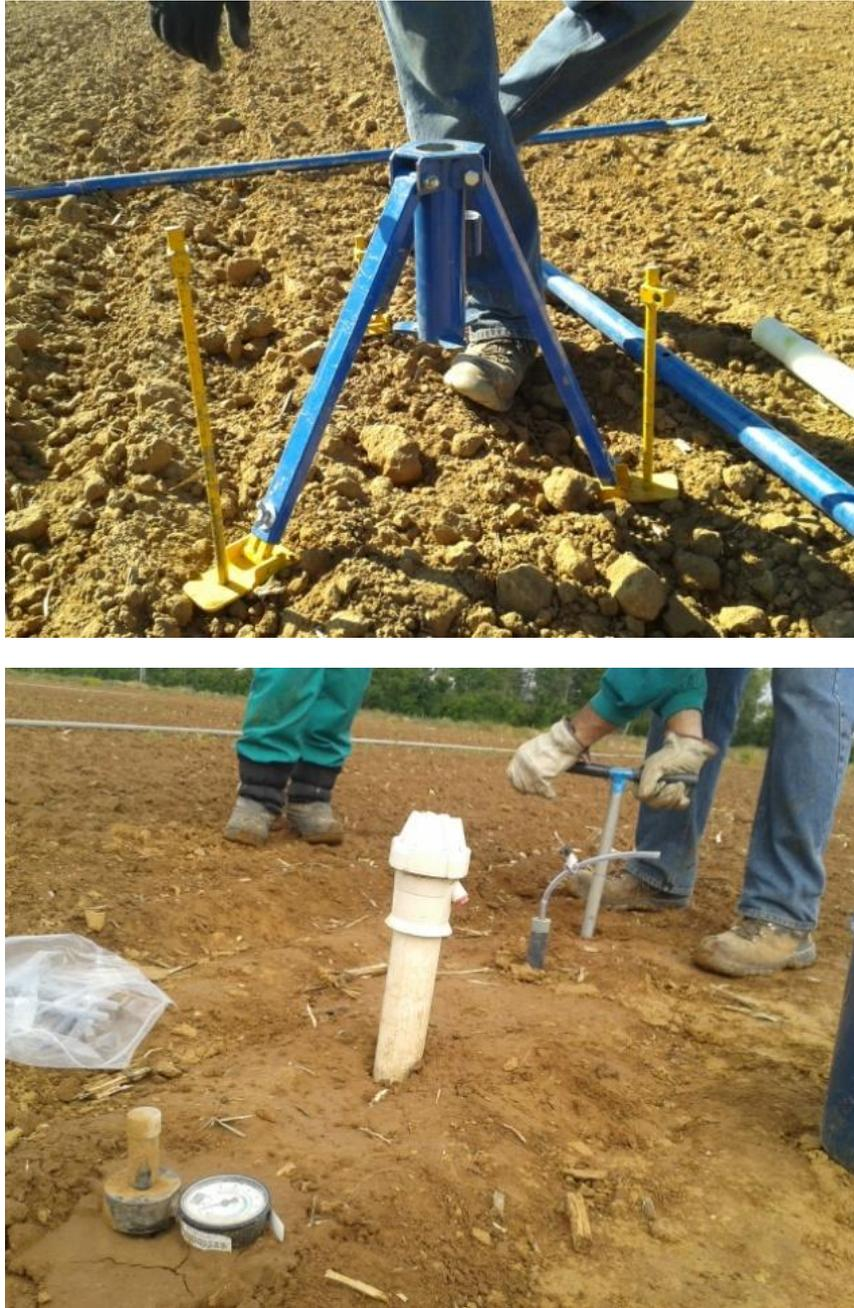
Figura 12. Equipo de instalación de los tubos de acceso, tensiómetros y equipos complementarios del régimen hídrico en el suelo.
