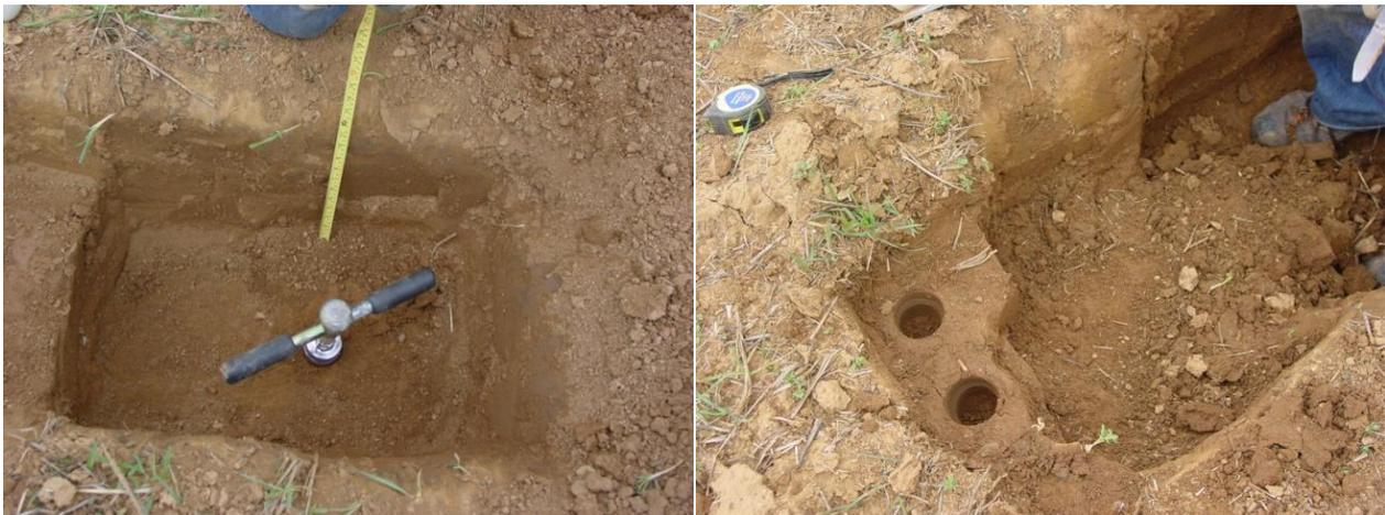
Figura 10. Recogida de muestras de suelo inalteradas para determinar la densidad aparente (07-03-12).
