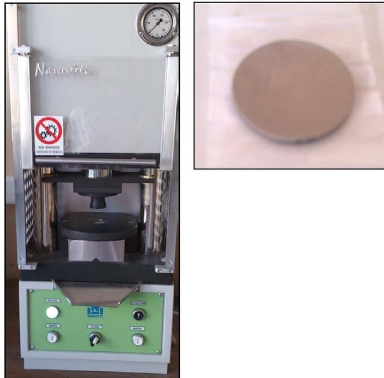
**Figura 20.** Prensa hidráulica (a) y pastilla utilizada en FRX (b)
