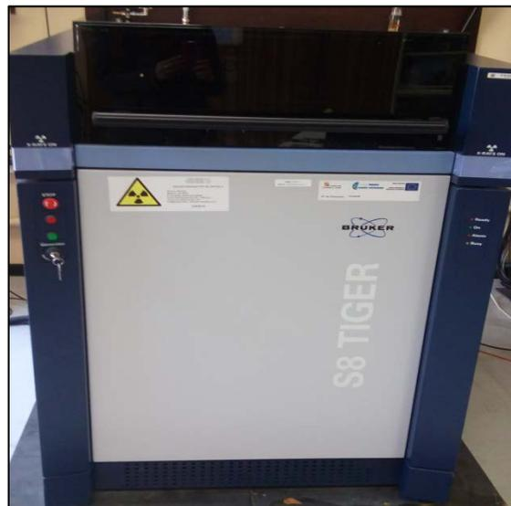
**Figura 21.** Equipo de Fluorescencia de Rayos X utilizado.
