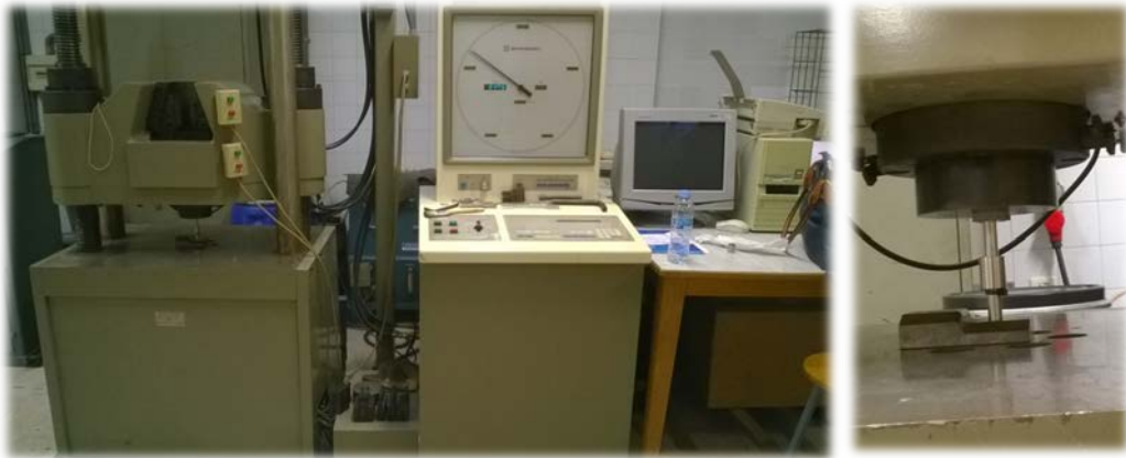
Imagen 2.2.g: Imágenes tomadas durante el proceso de compactación. Izquierda: prensa hidráulica. Derecha: detalle de los pistones y la camisa.
