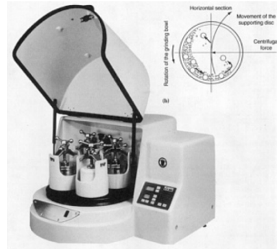
Imagen 2.2.e. Molino tipo planetario, modelo Fritsch Pulverisette. [11]
