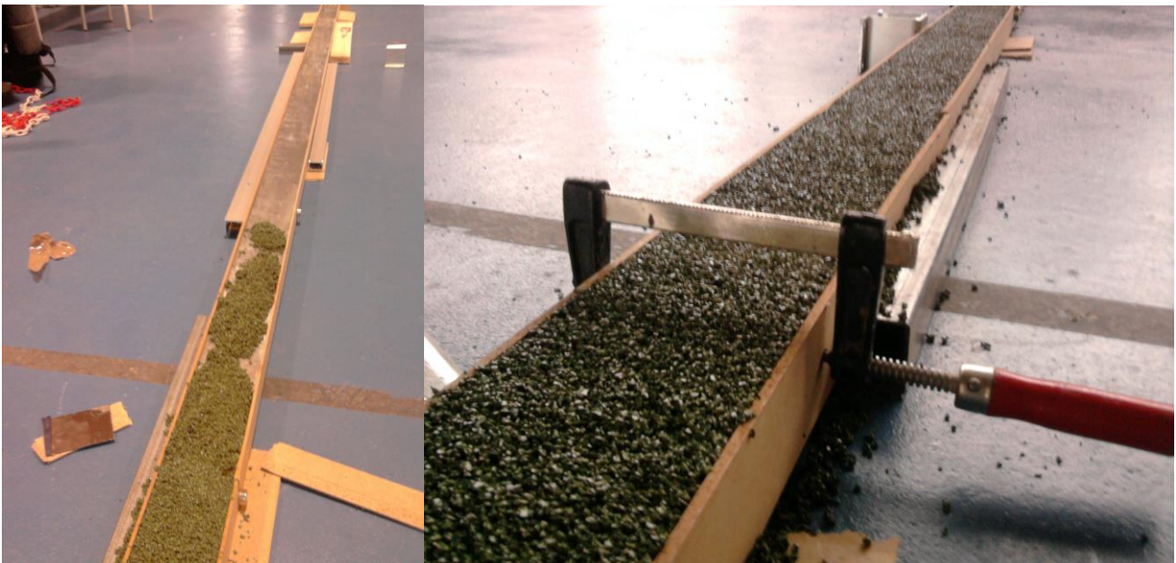
Figura 4.3. Creación de la capa de caucho sobre la viga.
