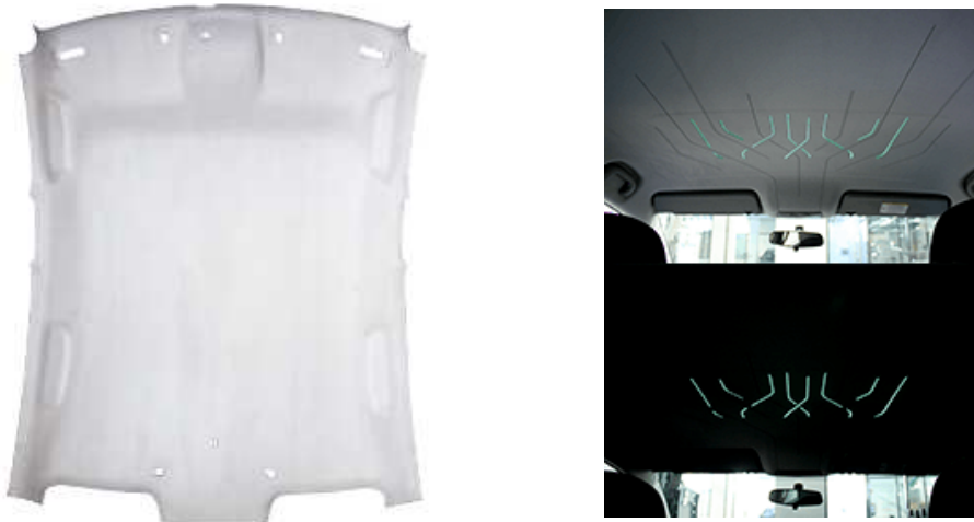
Figura 22. A la izquierda, techo interior de un Jaguar. A la derecha un techo, que después del revestido, es laseado mediante un proceso preparado para diferentes diseños y geometrías a partir del cual se obtienen aspectos variados como los efectos día y noche. También es posible la variación multicolor (RGB).
