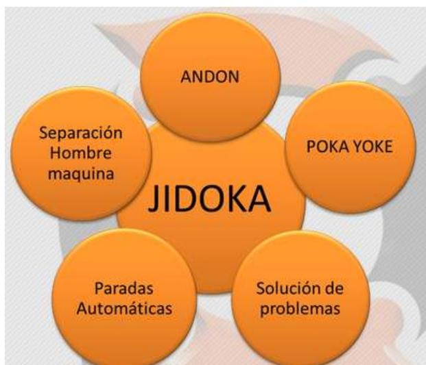
Figura 2-14 Configuración que sustenta el jidoka [Conestec. 2015]
