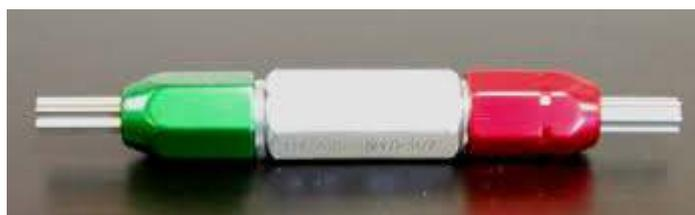
Figura 5-14: Útil medición entra para medidas interiores
