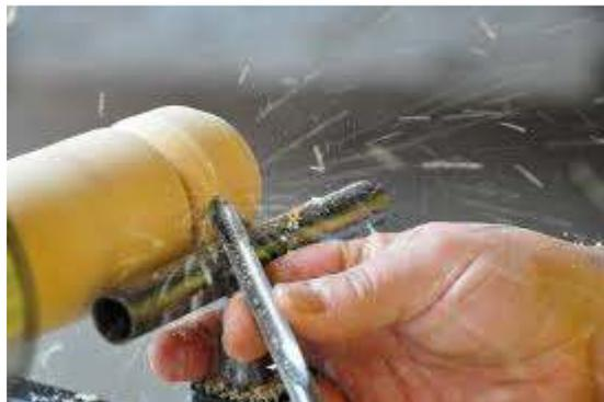
Figura 3-14. Proceso de torneado manual. [Monografías]
