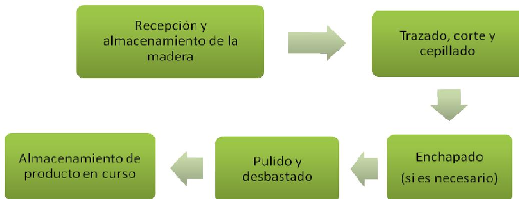
Figura 3-6. Flujo de la madera del tablero horizontal
