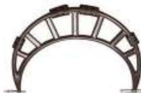
Figura 5-15: Útil comprobar medidas exteriores
