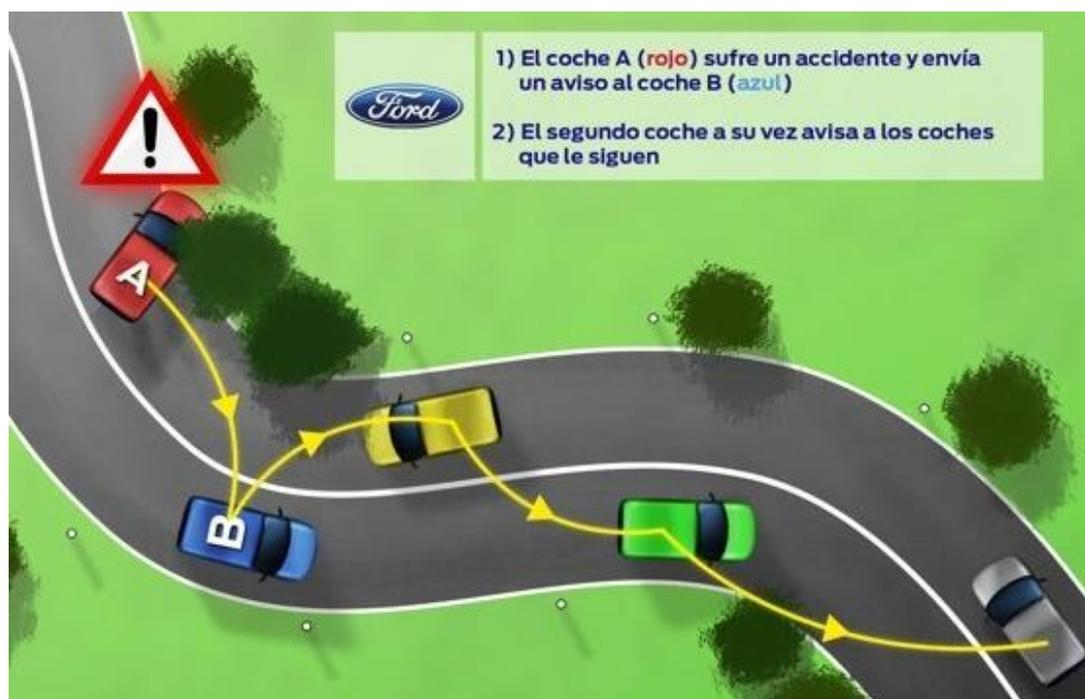
Figura 5. Sistema Ford CoCarX de intercambio de información entre vehículos. (Xataka.com, 2011)
