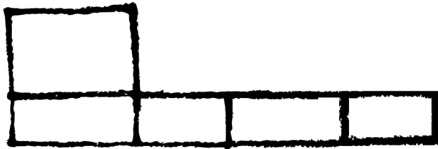
Desarrollo de la caja en "L" con representación gráfica de las pestañas que aparecen por duplicado, y su correspondiente montaje.
