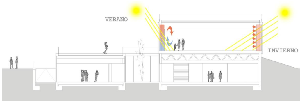
Figura 53: Esquema del funcionamiento de la envolvente acristalada en invierno y verano. Fuente: elaboración propia.
